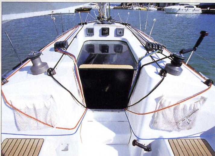
A sinistra, un particolare dei larghi passavanti con le due rotaie separate per l'olimpico e il genoa 1 e 2. Sotto, il pozzo della catena con la base per il salpancora opzionale che ne limita l'accesso.
