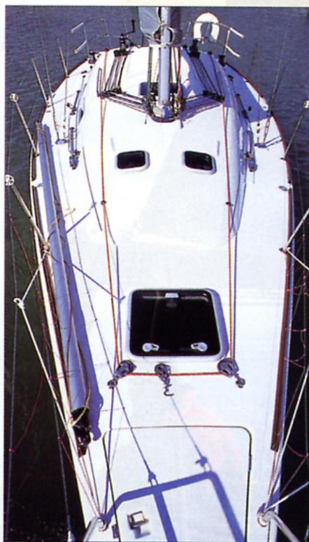
A sinistra, una vista da prua della coperta con il caricabasso sdoppiato del tangone a bilancino. Sotto, un dettaglio del fitting per la regolazione del genoa e dello spi.
